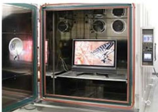
飛行する高度を想定した気圧と温度変化を再現した試験が可能な装置です。
