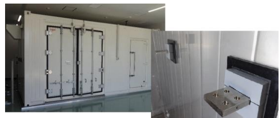
外部短絡試験装置外観と端子部
