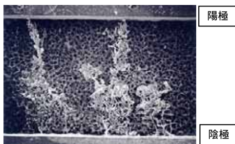
図7. 結露サイクル試験後のガラスエポキシ基板(はんだコート電極)に発生したイオンマイグレーションのSEM像
